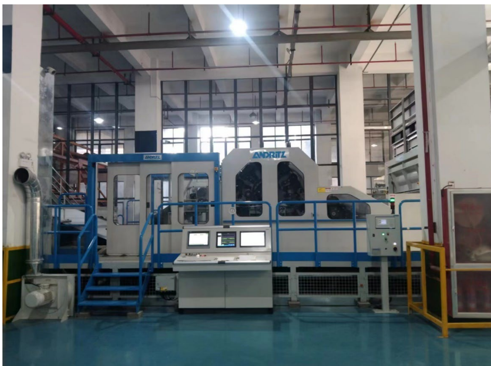
Third ANDRITZ needlepunch line in operation at Meisheng plant 梅盛工厂的第三条安德里茨针刺生产线
